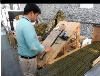
治具による支柱加工
